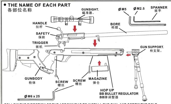
FOLLOW THE DIRECTION OF THE ARROWHEAD TO INSTALL THE GUN, AND SCREW THE BOLT. 跟随箭尖方向安装枪体,并拧紧螺丝。
